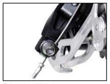
Tighten the cable bolt.
